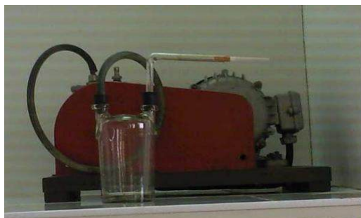
Рис. 1. Установка для получения водных вытяжек табачного дыма
