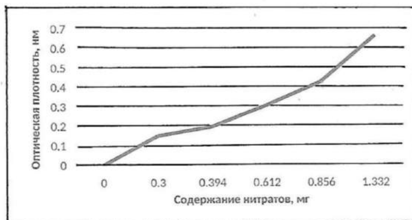
Рис. 2. Зависимость оптической плотности раствора от концентрации нитратов
